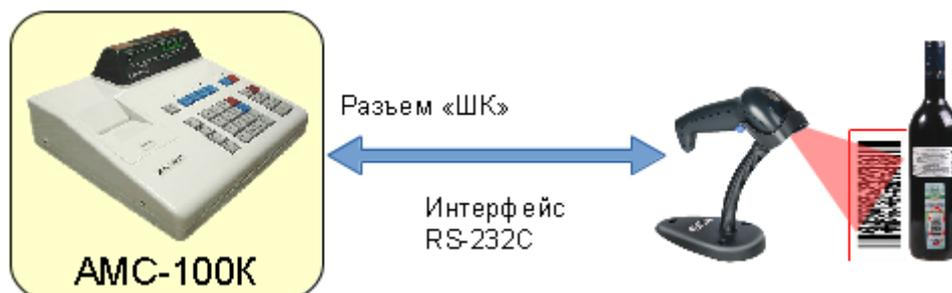
Также возможно подключение сканера с интерфейсом USB через **переходник USB Host - RS232C**.
